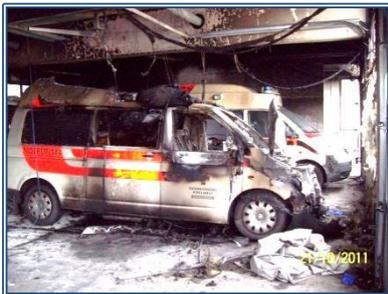
verteilte Stoffe brennen wegen ihrer größeren aktiven Oberfläche besser als homogene große Materialblöcke. Thermoplastische Kunststoffe schmelzen bevor sie verbrennen während Duroplaste ohne Änderung des Aggregatzustandes verschmoren. Eisen- und Stahlobjekte weisen eine charakteristische Anlauffarbe auf.
